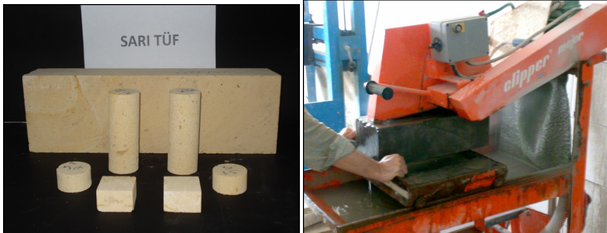
Şekil 2. Araştırmada kullanılan test numunelerinden "sarı tuf" ün görünümü.
