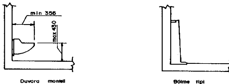
Şekil 6. Bide tipleri (Ölçüler mm dir).
