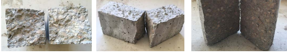
Şekil 2.1. Üretilen betonlardan eğilme ve yarmada çekme deneyi sonrasında elde edilen yüzeyler
