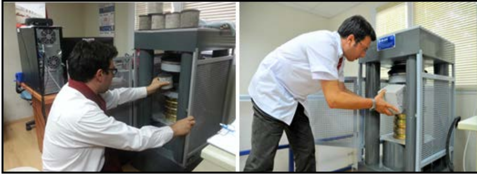
Şekil 2.5. Küp ve silindirik numunelerin tek eksenli basınç deneyine tabi tutulması
