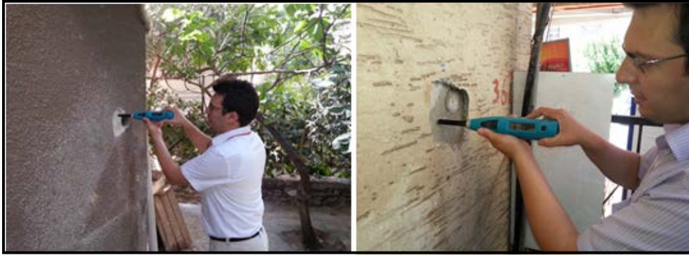
Şekil 2.3. Yerinde yapılan Schmidt test çekici uygulaması
