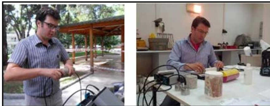
Şekil 2.8. Numuneler üzerinden ultrasonik yöntemin uygulanması
