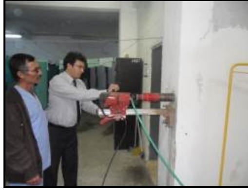
Şekil 2.4. Karot makinesi ile numune alımı
