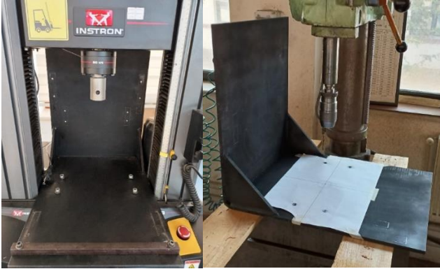
Şekil 6. Test düzeneği delik delme işlemi
