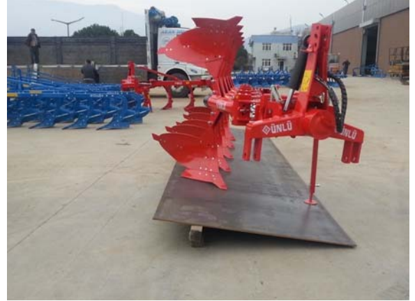
Şekil 9. Örnek Makine ve Makine Parçalarının Dengesinin Kaybolması Riski. UYGUN
