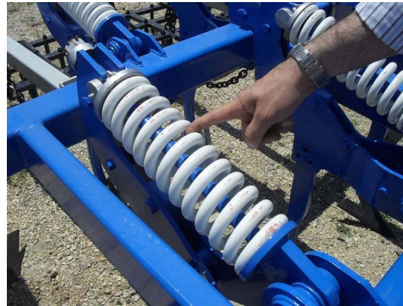
Şekil 6. Örnek Ezilme Sıkışma Riski . UYGUN DEĞİL
