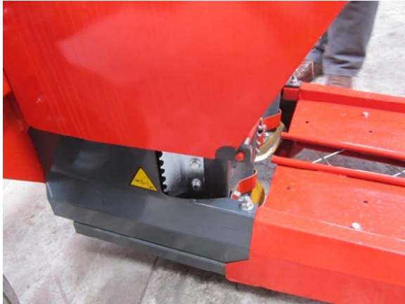
Şekil 12. Kesme Koparma Tehlikesi. UYGUN DEĞİL
