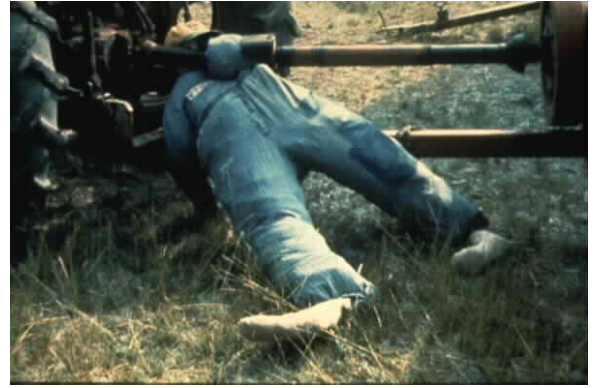
Şekil 10. İnsan Hataları ve İnsan Davranışları. Şaft Muhafazasının Çıkarılması. UYGUN DEĞİL
