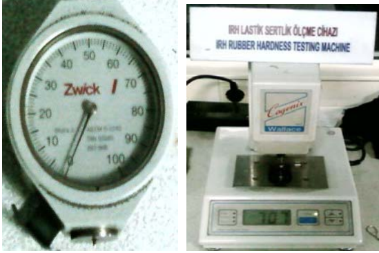
Şekil 3. Shoremetre (durometre) ölçüm cihazı
