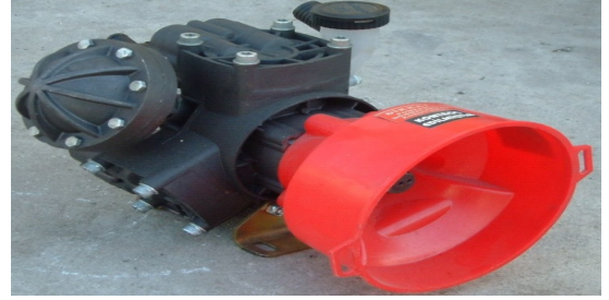
Şekil 5. Denemelerde kullanılan piston-membranlı pompa
