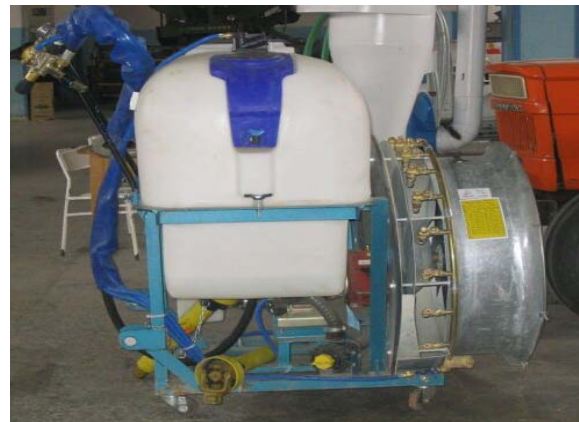
Şekil 1. Denemelerde kullanılan konvansiyonel yardımcı hava akımlı bağ-bahçe pülverizatörü
