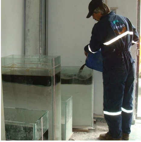
Şekil 4. Katı atık sızıntı suyunun deney düzeneklerindeki minyatür sahalarla dikkatlice boşaltılması
