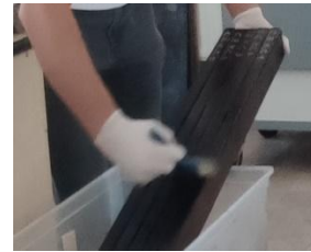
Fotoğraf 3. Deney örneklerinin karbonlaştırma ve keten yağı uygulama düzeneği (Carbonization and linseed oil application setup of test samples)
