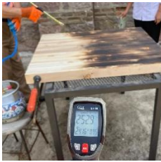
Fotoğraf 3. Deney örneklerinin karbonlaştırma ve keten yağı uygulama düzeneği (Carbonization and linseed oil application setup of test samples)
