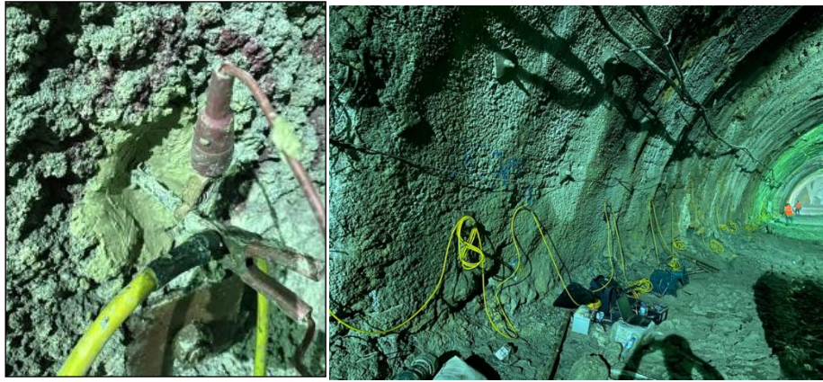
Şekil 6. EÖT’de kullanılan özel üretim elektrotların tünel duvarına yerleştirilmesi (solda) ve ölçü alımı (sağda) (Placing the specially produced electrodes used in ERT on the tunnel wall (left) and measurements (right))
