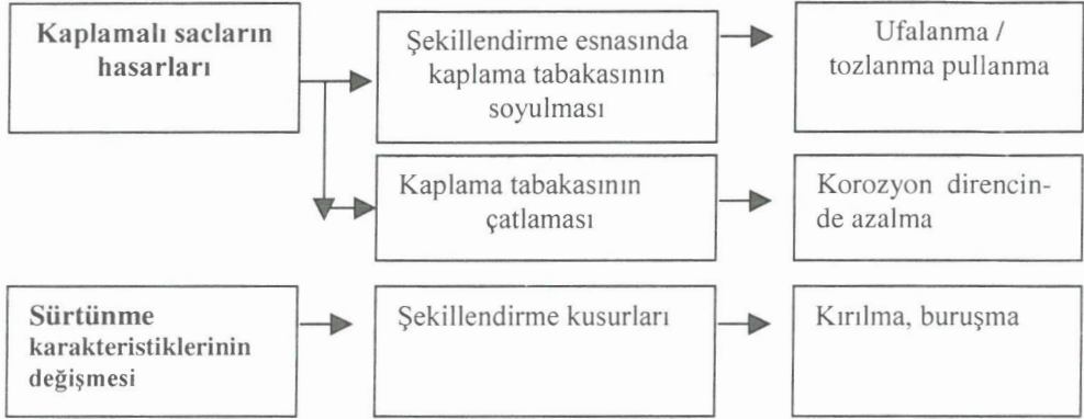
Şekil 1. Kaplamalı Sacların Şekillendirilmesinde Karşılaşılan Güçlükler [10].
