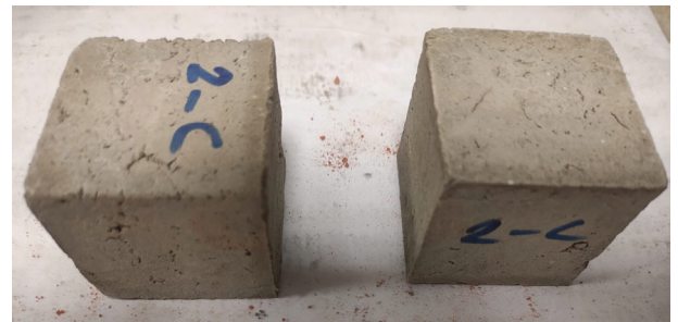
Şekil 4. Kocaeli Üniversitesi Mühendislik Fakültesi Yapı Malzemeleri Laboratuvarı'nda Üretilen Çimento Bağlayıcılı Briket Malzemeler.
