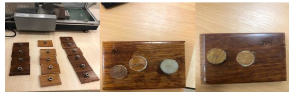
Şekil 2. Yüzey yapışma işlemi öncesi ve sonrası deney örnekleri / Figure 2. Experimental samples before and after surface adhesion treatment
