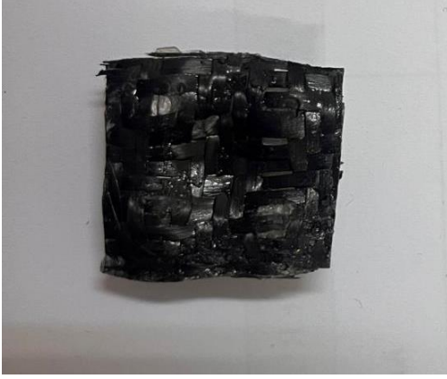
Şekil.3 Karbon fiber kaplama yapılmış TPMS kafes yapısı.
