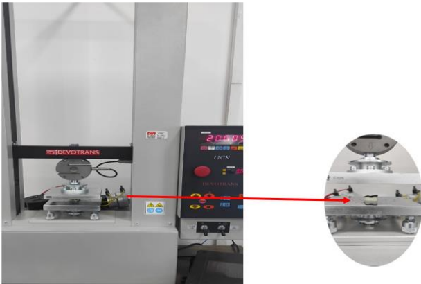
Şekil 4. Basma Test Cihazı ve Modelin Test Sırasındaki Örnek Görüntüsü.
