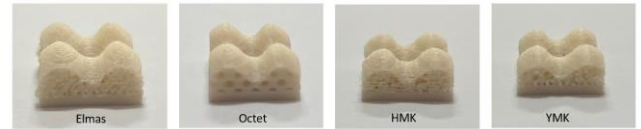
Şekil.2 Üretilen TPMS kafes yapıları.
