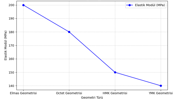
Şekil.8 TPMS kafes yapılarının elastik modül değerleri.
