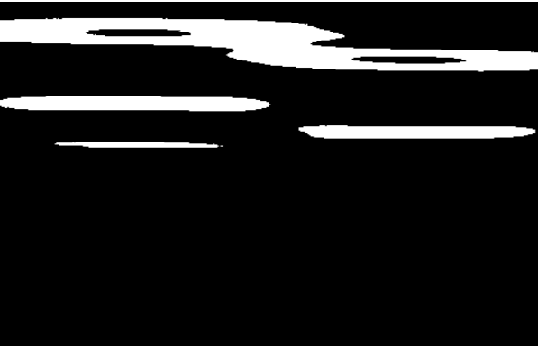
Şekil 11. Silindir hedefinin alt kısmının ZFG görüntüsünün Bulanık C-Ortalamalar algoritması kullanılarak elde edilen 2 seviyeli görüntü bölütlemesi
