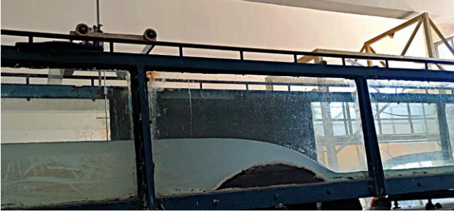
Şekil 7. P=0.08 m ve L=0.53 m olan savak için yapılan deney
