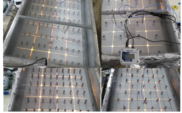
Şekil 2. Isı transfer elemanı alüminyum ve bakır silindirik kanatçıklar.
