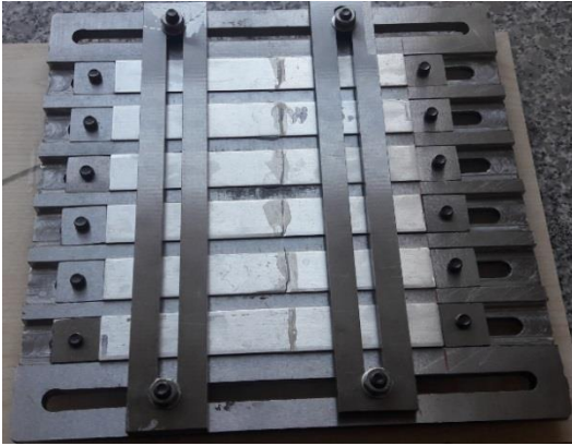
Şekil 4: Deney numunelerinin elde edilmesinde kullanılan kalıp sistemi
