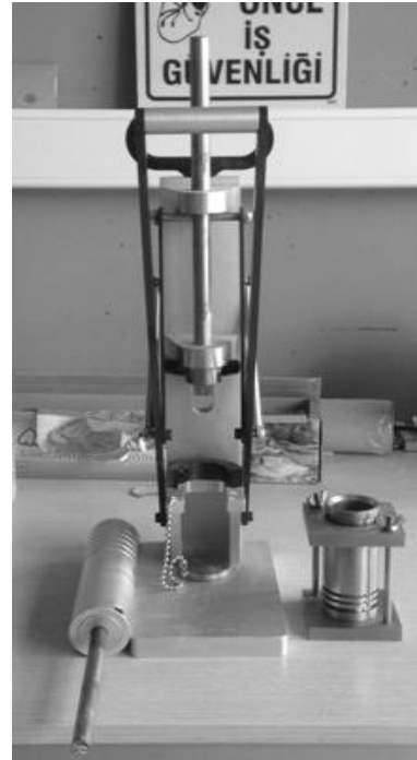
Şekil 1. Minyatür harvard kompaksiyon ekipmanı
