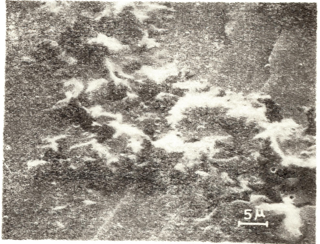
Şekil 5 : Mavi Bingham fluoritinde yüzeyde katılaşmış sıvı kapanımının yapısı, 2000 x.
