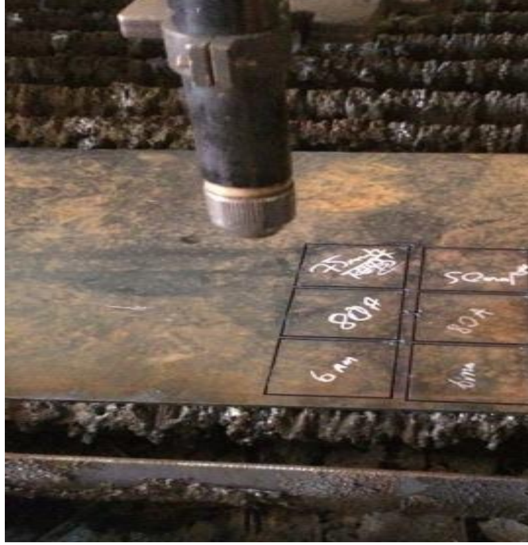
Şekil 1. Numunelerin CNC plazma ile kesimi
