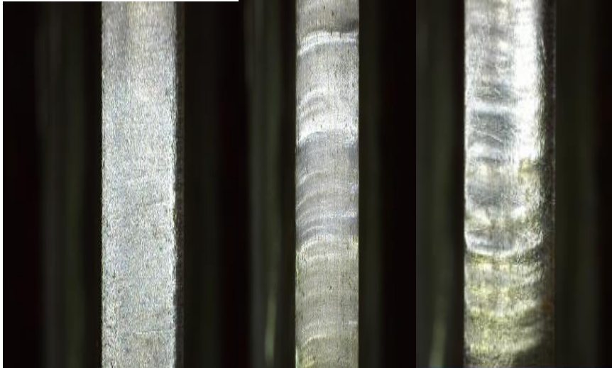
Şekil 4. 6 mm, 80A'de 50, 75 ve 100 mm/dk. kesim sonucunda yüzeylerin makro görünümü (x20)
