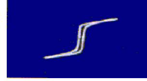
Şekil 7. Tek faz geriliminde bağımsız olarak ölçülen, üç bacaklı üç faz transformatörde A fazındaki histerezis eğrisi.
