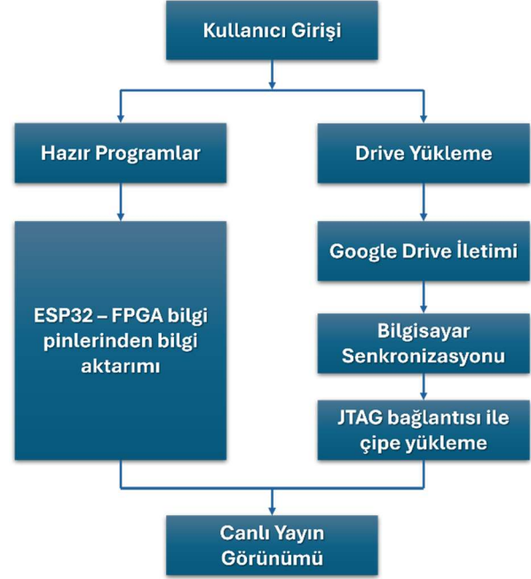
Şekil 4. FPGA tabanlı uzaktan programlanabilir ve gözlemlenebilir sistem akış şeması
