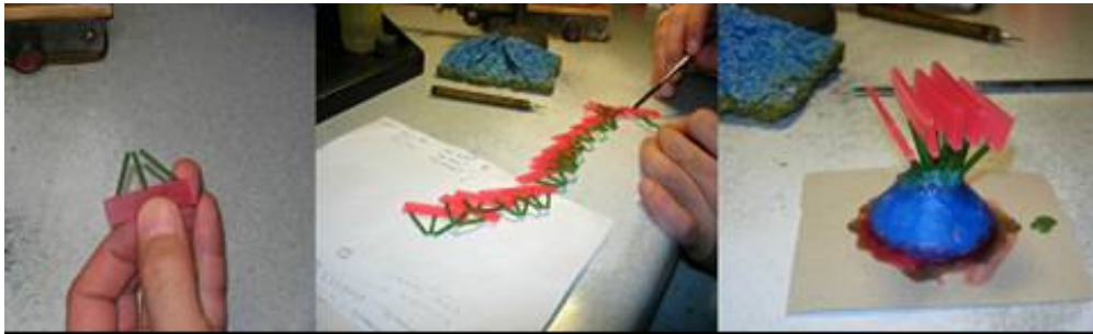
Şekil 1. Döküm işlemi için yollukların yapımı ve numunelerin tutturulması
