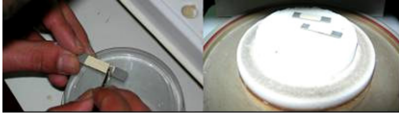
Şekil 4. Opak sürme işlemi ve fırına gönderilme işlemi.
