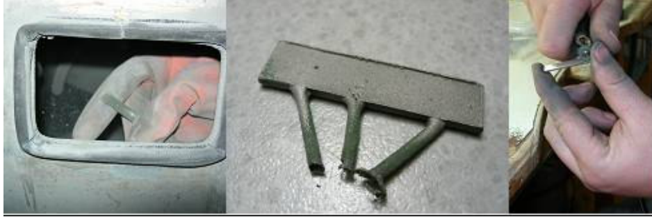
Şekil 3. Kumlama işlemi ve sonrasında numune ile yapılan tesviye işlemi.
