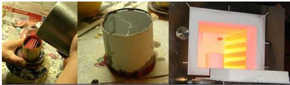
Şekil 2. Revetmana alma ve fırınlama işlemi
