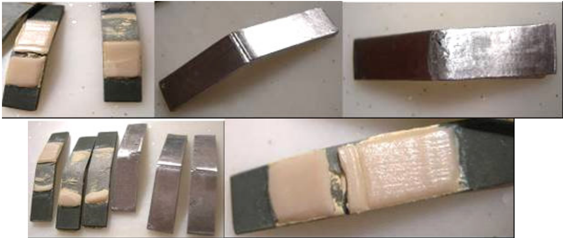
Şekil 8. Üç nokta eğme deneyi sonrası numuneler.
