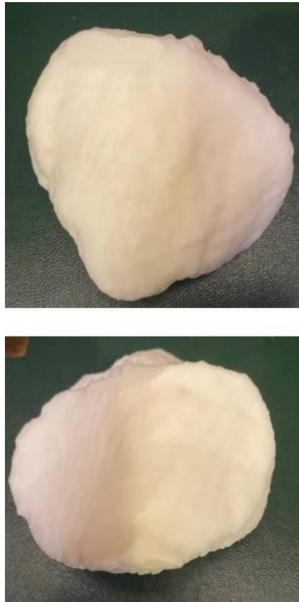
Şekil 3: 3D yazıcı ile bastığımız patella modelleri.
