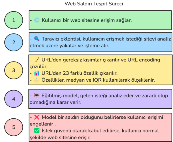
Şekil 10. Modelin gerçek zamanlı çalıştırmak için yapılan işlemler.
