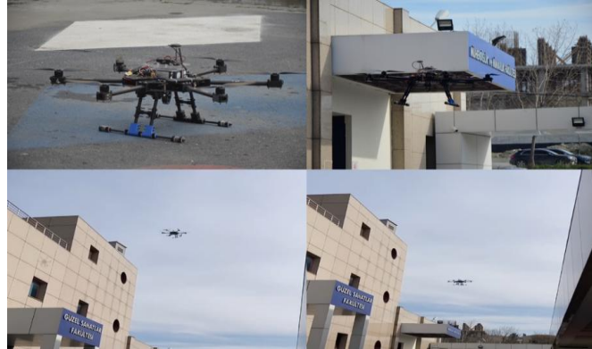
Şekil 29: Hexacopter yapısındaki hava aracına ait uçuş testi görüntüleri
