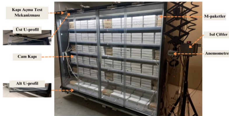
Şekil 3. Test odasındaki TTS ve test ekipmanları (TTS and test equipment in the test room)
