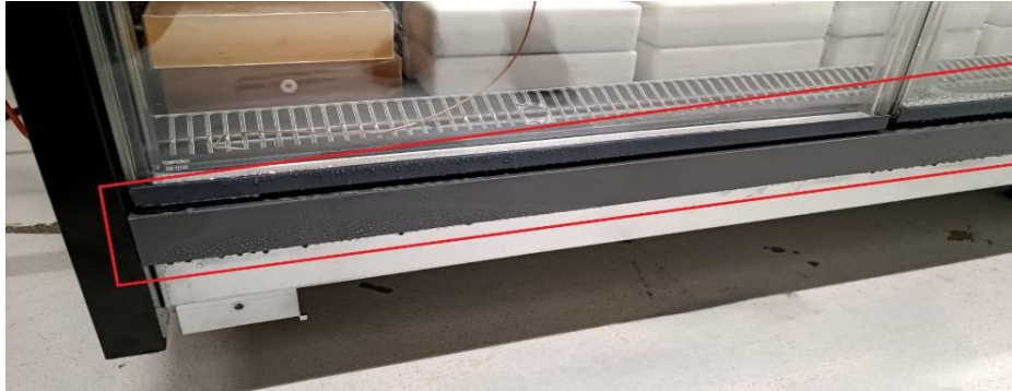
Şekil 1. Profil yüzeyinde oluşan yoğuşmaya ait görsel (Visual of the condensation formed on the profile surface)
