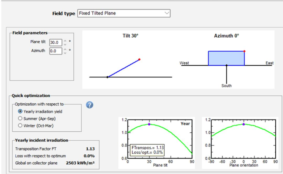
Figure 4. Orientation of solar panels (Güneş panellerinin yönlendirilmesi)
