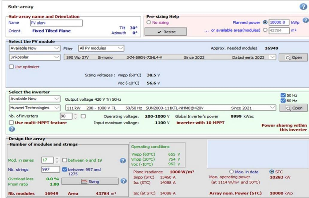
**Figure 7.** The interface where parameters are entered for a 10 MWp capacity power plant using the PVsyst program (PVsyst programı kullanılarak 10 MWp kapasiteli bir enerji santrali için parametrelerin girildiği arayüz)
