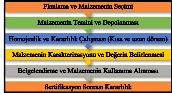
Şekil 1. Referans Malzeme Üretimi Akış Şeması (Reference Material Production Flow Chart)
