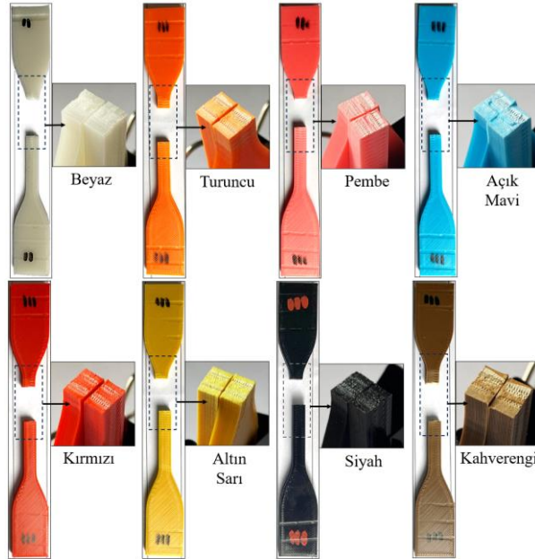
Şekil 5. Çekme deneyi sonrasında numunelerin kırılma yüzey görüntüleri
