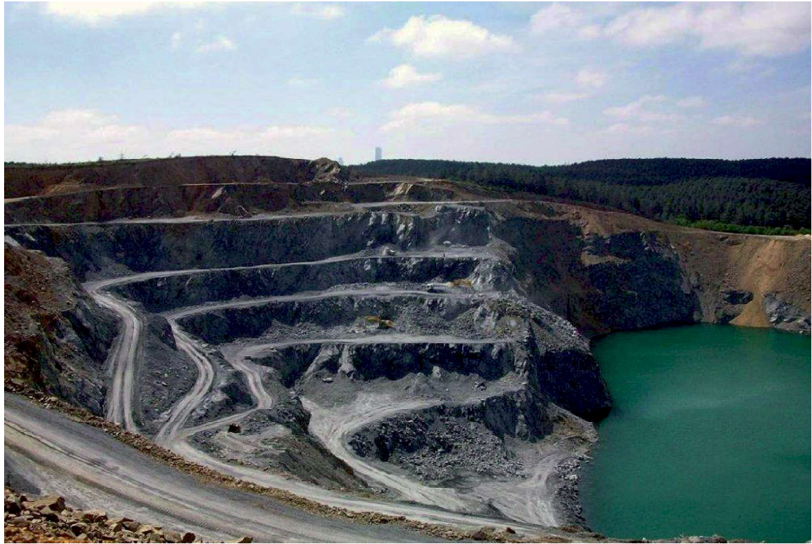
Şekil 21. Ayazağa köyü Cendere vadisi mevkiinde bulunan Trakya formasyonunun Küçükköy üyesinin mikalı kumtaşları (grovaklar) içinde açılmış agrega (kırmataş) ocağı.
