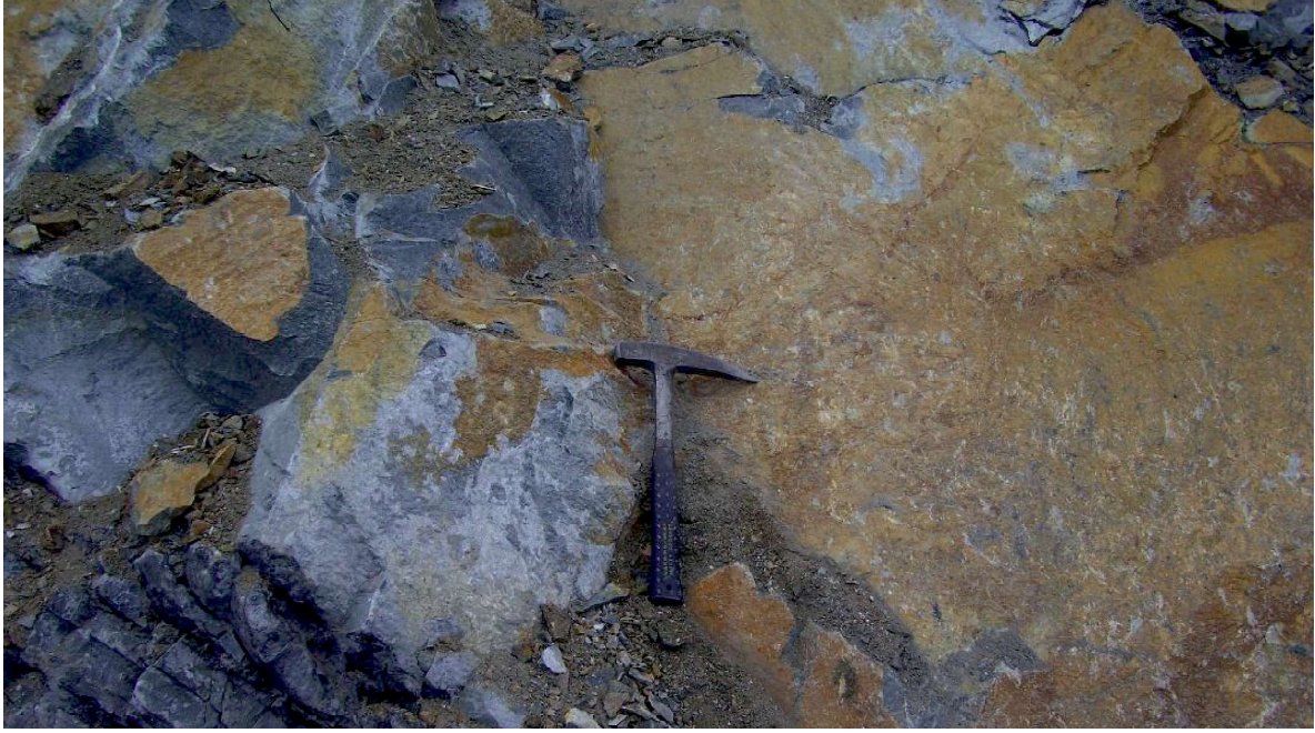
Şekil 20. Trakya formasyonunun Küçükköy üyesini oluşturan mikalı kumtaşlarının (grovakların) arazideki görünümü (Ayazağa-Cendere agrega ocağı).
