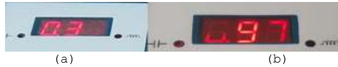
Şekil 12. Kompanzasyon öncesi (a) ve sonrası (b) \cos\phi değerleri (Figure 12. Before (a) and after (b) compensation, \cos\phi values)
