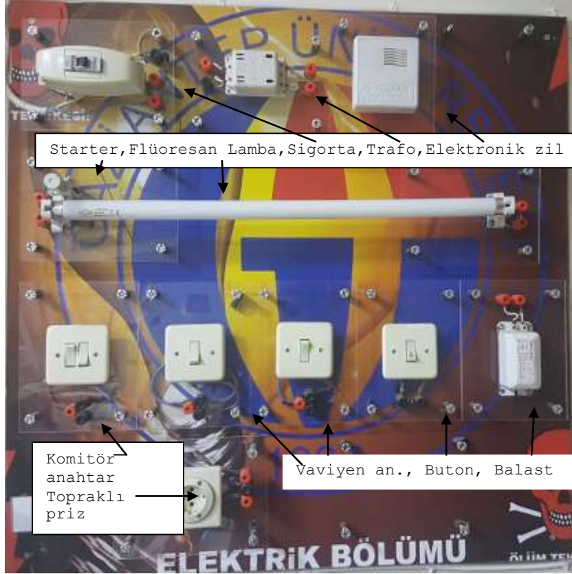
Şekil 4. Kuvvetli ve zayıf akım tesisatı elemanları (Figure 4. High and low current installation elements)
