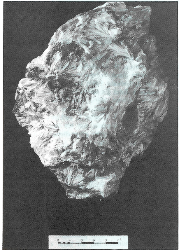
Şekil 10. Kolemanitin hidroborasite ayrışması sonucunda gelişen kolemanit-hidroborasit birlikteliği, Hisarcık ocağı, Emet. Figure 10. Colemanite and hydroboracite coexisting due to colemanite alteration to hydroboracite, Hisarcık mine. Emet.
