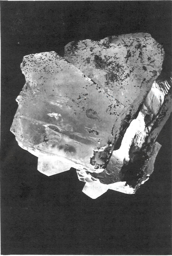
Şekil 8. Yüzeyden itibaren çok ince bir film tabakası halinde tinkalkonite dönüşen boraks kirstalleri, Sarıkaya açık işletmesi, Kırka. Figure 8. Borax crystals with tinalconite formation as a thin film coat on surface, Sarıkaya opencast mine, Kırka.
