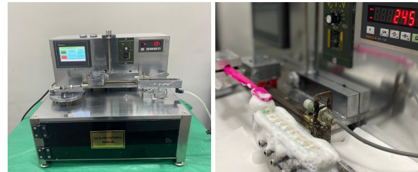
Şekil 3. Çalışmada kullanılan Tağtekin & Korkut tarafından tasarlanan basınç sensörlü ve kuvvet ayarlı fırçalama cihazı
