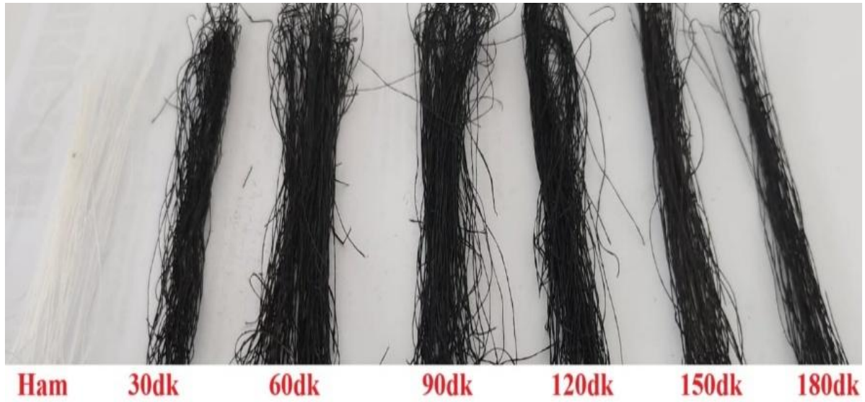
Şekil 4. Ham kenevir ve FA-BA emdirilmiş stabilizasyon numunelerinin renk değişimi
