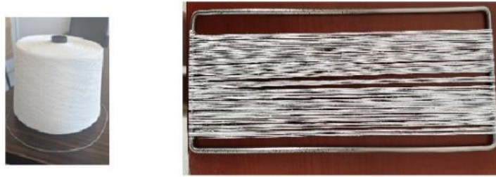
Şekil 2. Ham %100 kenevir ipliği ve paslanmaz çelik numune tutucudaki sarım görseli
