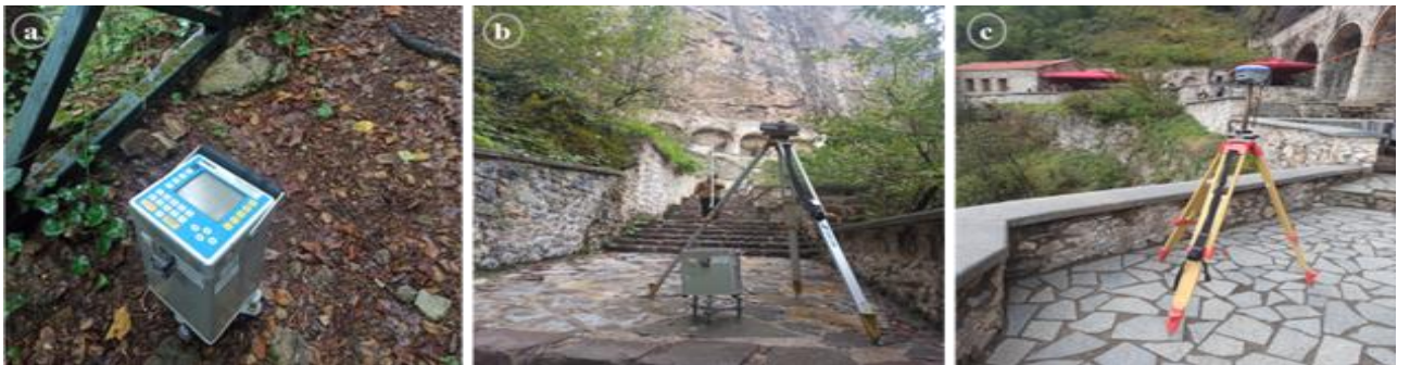
Şekil 2. Arazide kullanılan cihazlar (a) Bağıl gravimetre (b) Nivo (c) GNSS RTK alıcı
