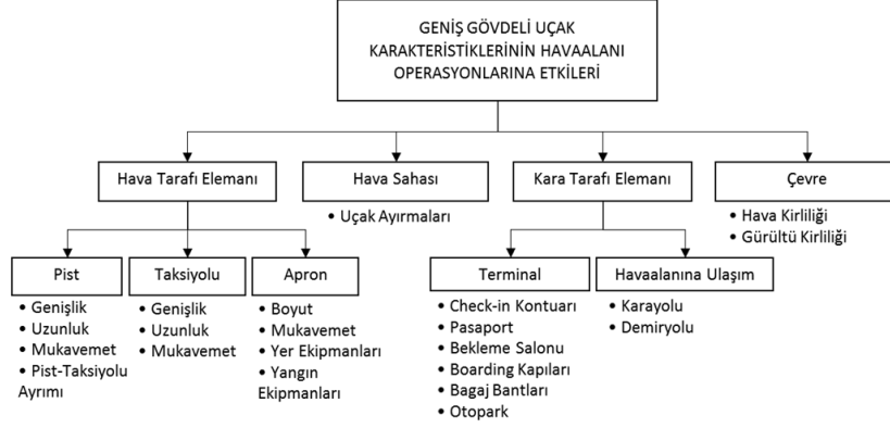
Şekil 1: Geniş Gövdeli Uçak Karakteristiklerinin Havaalanı Operasyonlarına Etkileri
