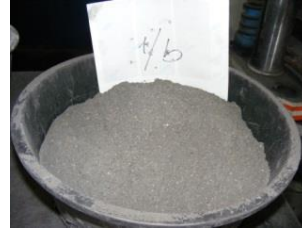
Şekil 2. Fren balatası tozlarının karışımı
