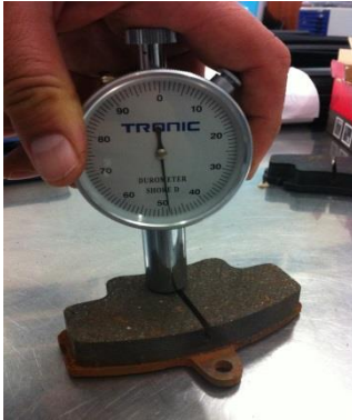
Şekil 4. Balata numunelerinin sertlik ölçümü
