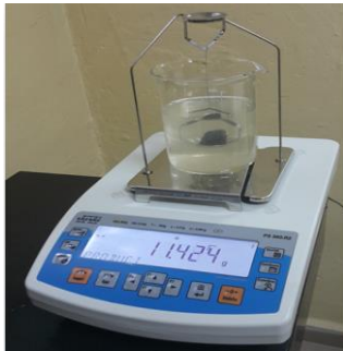
Şekil 5. Balata numunelerinin yoğunluk ölçümü
