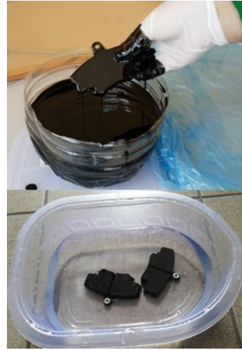
Şekil 6. Balataları suda ve yağda bekletme işlemi
