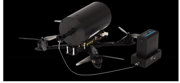
Şekil 4. Fiber optik kablolu bir dronun haberleşme sistem şeması.
