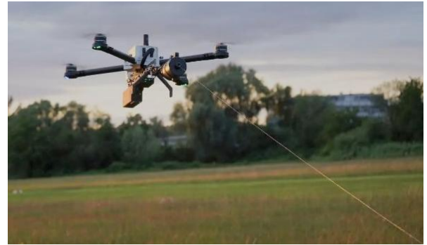
Şekil 5. Fiber optik haberleşme sistemine sahip dronun havadaki görüntüsü (Top War, 2024b).
