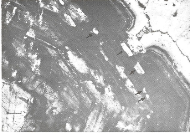
Şekil 27. İri plajiyoklaz minerali içinde çivi başına benzer yamaların (oklarla gösterilmektedir) genel görünümü (Şebinkarahisar-Dereli arasındaki granitoyid plütonundan alınan DŞ-48 no'lu kayış örneđi, çift nikol, çizgisel ölçek 0.2 mm).
