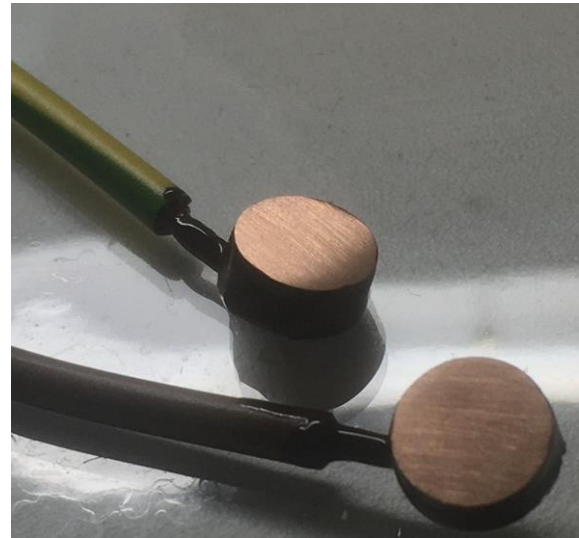
Şekil 2. Kaplama için hazırlanmış bakır altlıklar (Copper substrates which are prepared for deposition)
