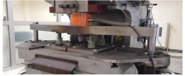
Şekil 9. Derin çekme işleminde kullanılan mekanik pres ve test düzeneği.
