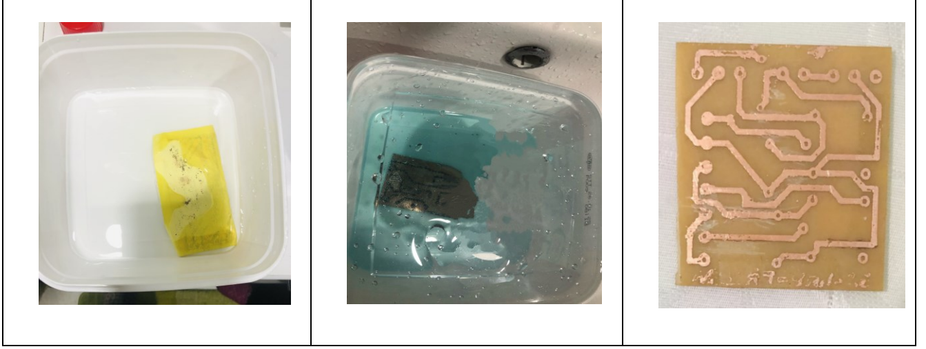
Şekil 7. Kimyasal karışımın hazırlanışı ve bakır plakette yolların çıkarılması.
