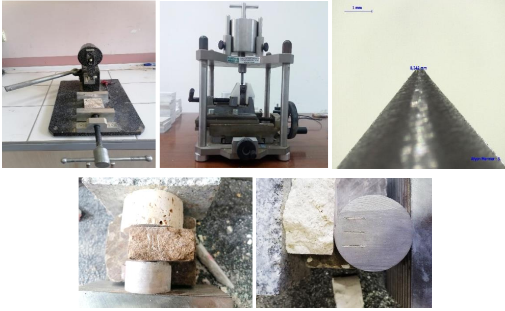
Şekil 1. CAI testlerinde kullanılan klasik (üst solda) ve West (üst ortada) deney aletleri; CAI testi sonrasında test ucunda meydana gelen aşınmanın mikroskop altında belirlenmesi (üst sağda), pürüzlü yüzeyde yapılan CAI testi (alt solda); kesilmiş (düz) yüzeyde yapılmış CAI testi (alt sağda)
