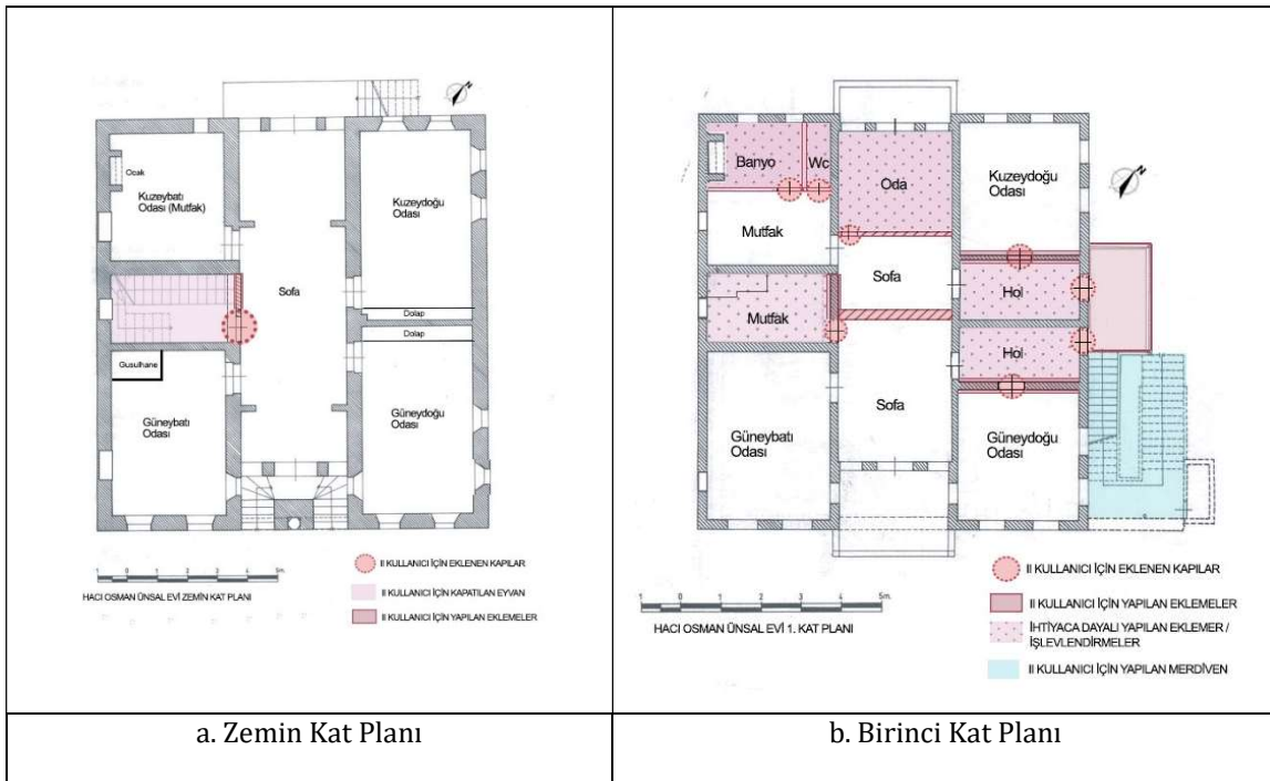
Şekil 9. Hacı Osman Ünsal Evi'nin I. Dönem kat planları ve yapılan değişikliklerin gösterimi (1960-1980) (Ata Ünsal, 2025: Erdal'ın 2000 yılına ait kat planlarından düzenlenmiştir.)
