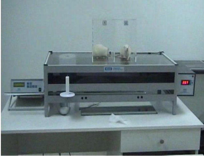
Şekil 1. Plantar test sistemi. Sistem gövde, zaman ölçme aleti ve ısıtıcıdan oluşmaktadır. Gövde, sıçanların konduğu cam tabaka ve bunun altında bir kolla istenen konuma hareket ettirelebilen termal radyan kaynağından oluşur. Zaman ölçme sistemi radyant enerjinin uygulanmaya başlaması ve sıçanın pençesini çekmesi arasındaki süreyi ölçer. Isıtıcı sıçanların bulunduğu cam plakanın ayarlanan sıcaklıkta kalmasını sağlar.
