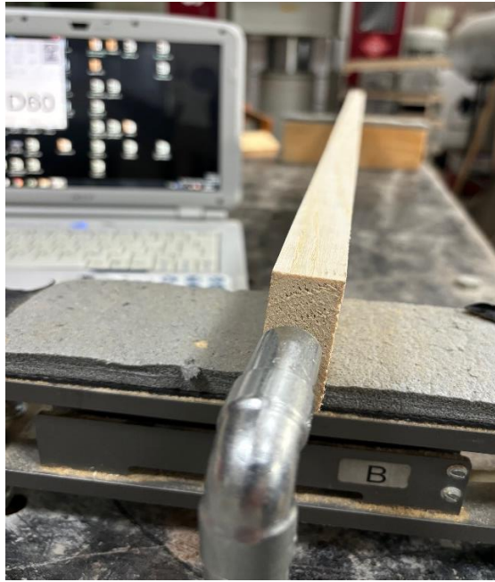
Şekil 2. Boyuna vibrasyon test düzeneği
