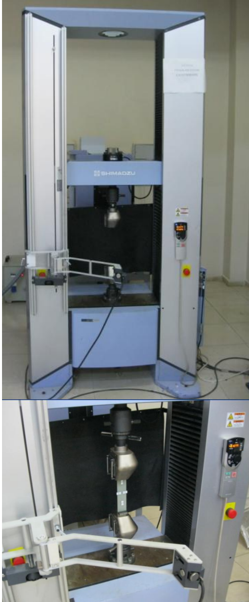
Şekil 1. Çekme cihazının genel görüntüsü ve çekme testi numunesinin test cihazına bağlanması
